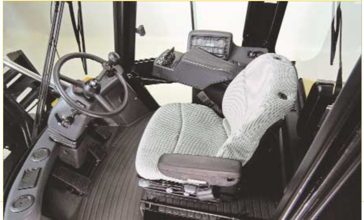
Carretilla mostrada con cabina cerrada opcional, pomo de dirección en el volante y asiento tapizado con suspensión de aire total.
