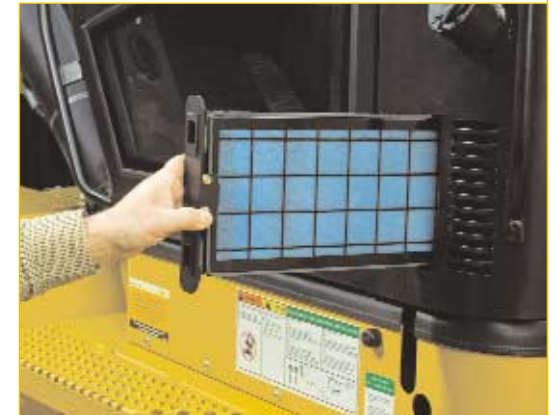
Acceso sencillo al filtro de aire de la cabina
